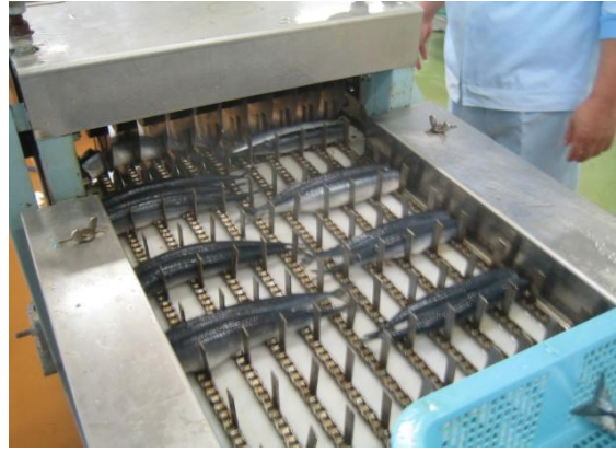
機械で缶詰の高さにカットします。
